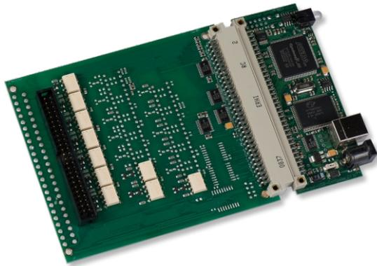
MultiChoice USB-Basic/Count8 im stabilen, form-schönen Aluminium-Gussgehäuse, acht 32- Bit-10-MHz-Ereignis-/Frequenzzähler Auflösung 1Hz oder Periodendauerzähler oder Pulsbreitenmessung, Auflösung 100/20ns, Eingangssignalpegel 2.4V bis 28V, 1000Volt Trennungsspannung. OEM Version Signalanschluss durch 50-poligen Pfostenstecker.
